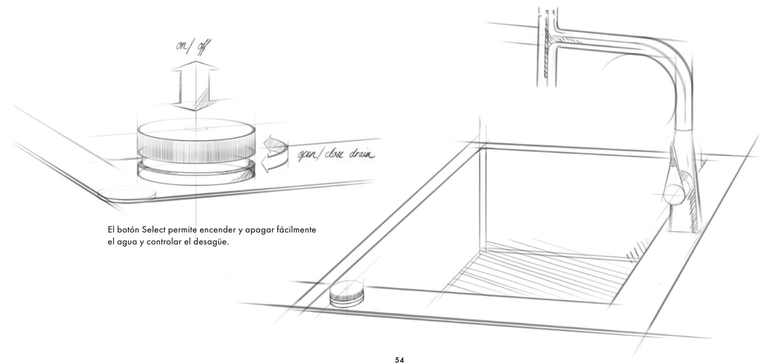
El botón Select permite encender y apagar fácilmente el agua y controlar el desagüe.
